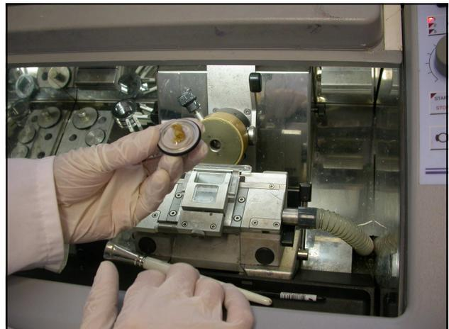
Fig. 1 : Cryostat avec le tissu dans l'OCT
