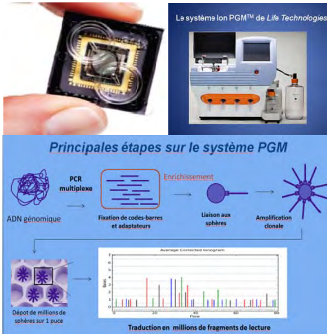
Fig. 2 : Puce, appareil de séquençage et résumé des étapes
